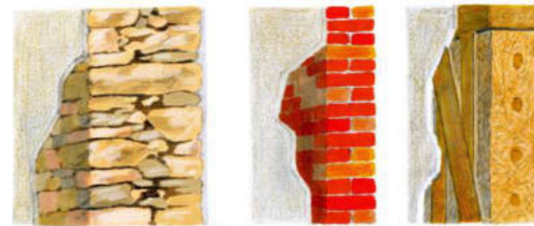
mur ancien souvent maçonné à la terre, enduits fins à la chaux (intérieur et extérieur) mur ancien en briques enduit au plâtre ou chaux mur en pan de bois et torchis enduit à la chaux
