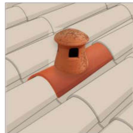
Principe de la tuile canal à douille avec lanterne, pour incorporation de sortie de ventilation en toiture.
